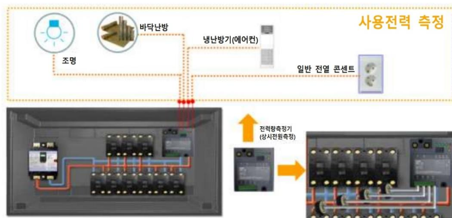
[그림 3] 에너지 성능평가 통합계측 시스템의 구성도
